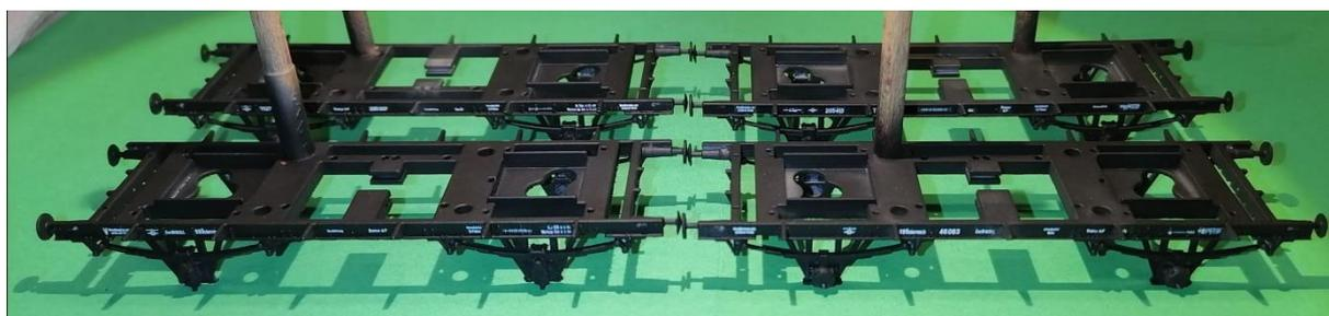
10) Einsetzen der Kurzkupplungskulisse Symoba Sy111 (KKK): An der zur Waggonmitte zeigenden Seite der KKK wird etwas Material abgetragen (bis 0,5 mm sind möglich):
