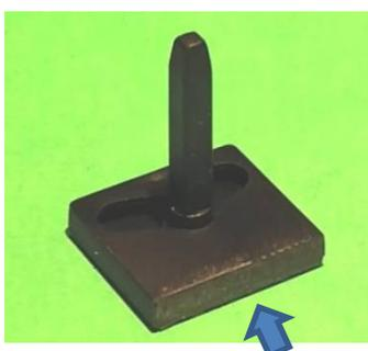
Danach wird der kleine Hohlzylinder (notfalls auf mind. 2,7 mm aufbohren) über den beweglichen Stift der KKK und geschoben und entsprechend der Höhe des Hohlzylinders abgelängt,
