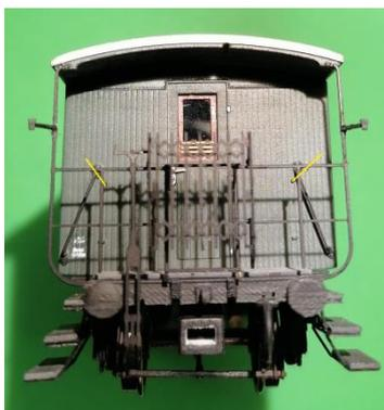
Danach werden die beiden dritten (schmäleren) Plattformbrettchen bzw. das Metallätzteil der Plattform zwischen Plattformwand und -geländer angepasst und verklebt. Es folgt die Vorlegestangen (offen oder versperrt).
