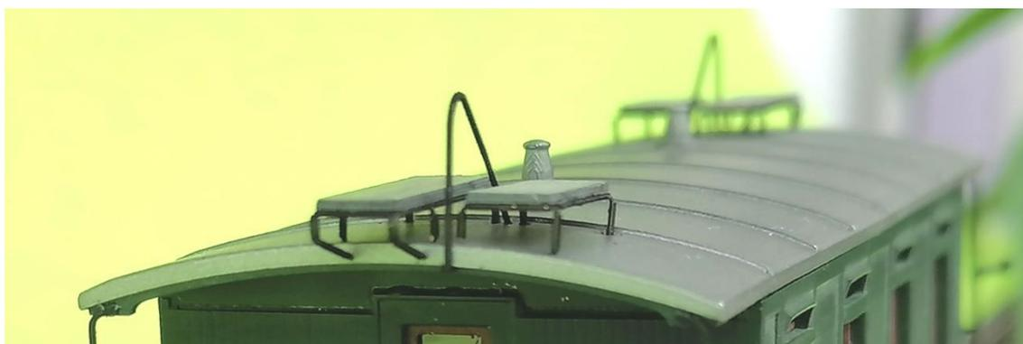
Die Handläufe am Dach werden an der Dachunterseite in die Kerbe und an der Dachoberseite das vorhandene Loch geklebt. Eventuell anzubringende Leitern werden den Vorbildfotos entsprechend verklebt.
