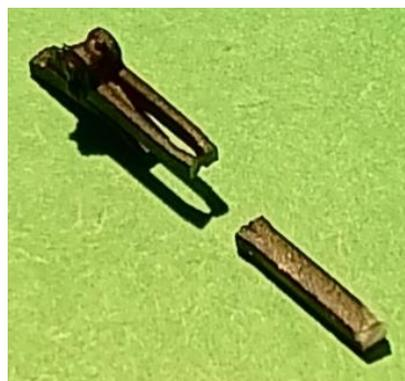
16) Einkleben der Bremsanlage: Man beginnt neben den Bügeln der Vakuumbremse mit den beiden einzelstehenden Teilen und setzt mit dem Teil mit 2 Bremsbacken Richtung Wagenmitte fort. Es ist darauf zu achten, dass die Bremsbacken mittig am Rad zu liegen kommen. Zum Schluss folgt das Teil mit den 4 Bremsbacken. Nach dem Einkleben werden die Überstände auf der Fahrgestelloberseite abgetrennt:
