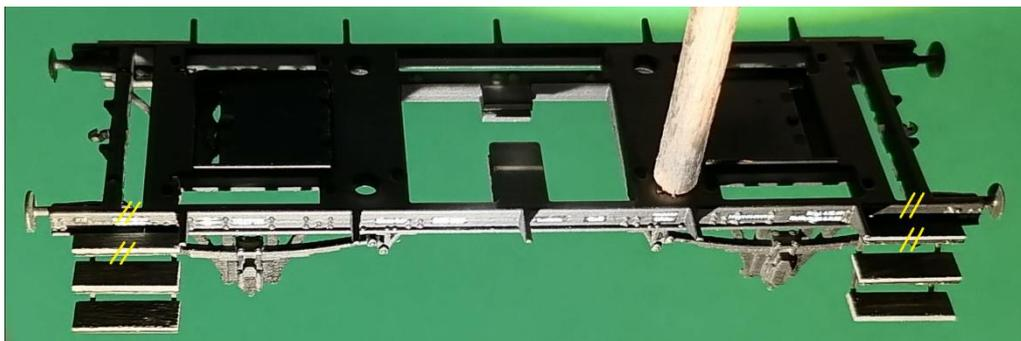
12) Einkleben der Druckluftbremsschläuche in die entsprechenden Nuten:
