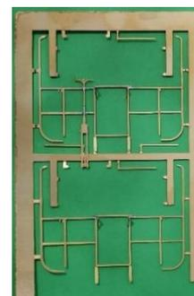
Da der untere Teil der Bremsspindel die Drehbewegung des NEM-Schachts, kann dieser untere Teil entlang der markierten ( → ) Ätznut abgetrennt werden. Eines der Plattformgeländer trägt linksseitig eine kleine (unten rot markierte) Auflagefläche für die Handbremse, die nun mit ihrer gleich großen Auflagefläche (rot) verlötet wird:
