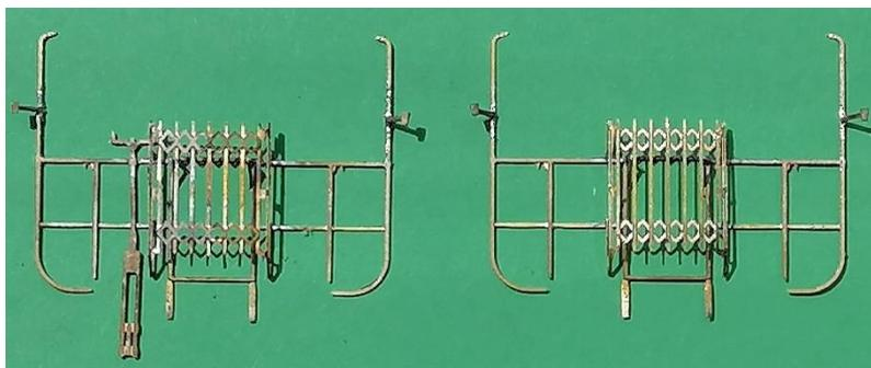
Die Übergänge der Wagen T-527 111 und 46080 waren lediglich durch Ketten gesichert. Die Herstellung der Kettenimitation erfolgt durch Verdrillen zweier dünner Messingdrähte und nachmaliges vorsichtiges Verlöten der Zwischenräume der beiden Drähte:
