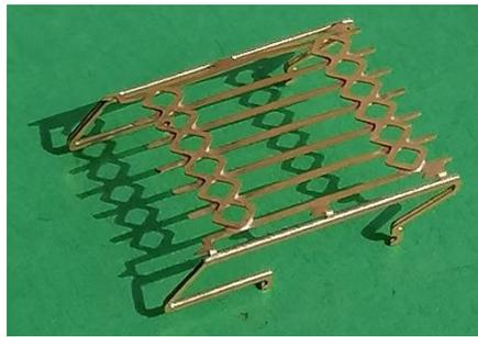
und danach in das Plattformgeländer eingehängt und verlötet. Zum Schluss werden die Signalhalter an die Griffstangen gelötet:
