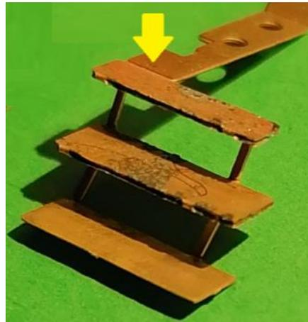
Nach dem Verlöten wird für die genaue Einstellung der Trittstufen die Schablone geformt und die Trittstufen wie folgt in die Schablone eingepasst, dass die Spitzen der Schablone mit den vorderen Abschlüssen der Trittstufen zur Deckung gebracht werden:
