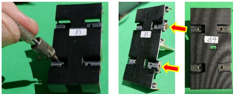
Danach wird die Inneneinrichtung an allen vier Seiten so lange an einem plan liegenden Schleifpapier abgezogen (Vorsicht: Bruchgefahr), bis sie leichtgängig in den Wagenkasten passt:
